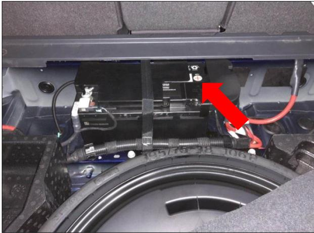
接正负极 :在电瓶处分别连接我司正极( 箭头 )
