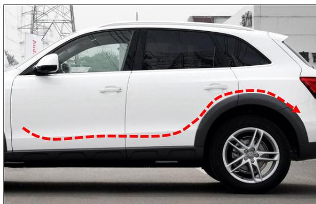
布正极线 :如图示意 ,把线束延伸到前面胶条通过后面胶条内延伸到尾门内部 ,
