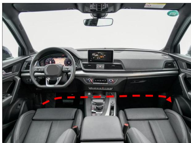
右踏板车内线束布线 :把车内线束通过脚下海绵 ,穿过此孔延伸至副驾驶位。( 虚线 ) 提示 : 右边踏板车内线束较长 :
