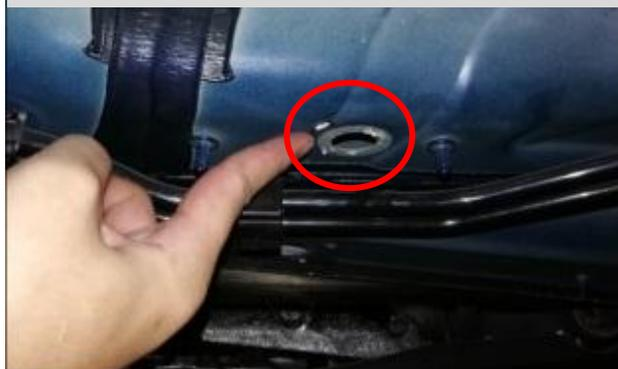
踏板线束布线 :在前门迎宾踏板底下侧裙边缘找到孔位 ,以打圈侧裙缺口为准 ,箭头位置为穿线孔 :
