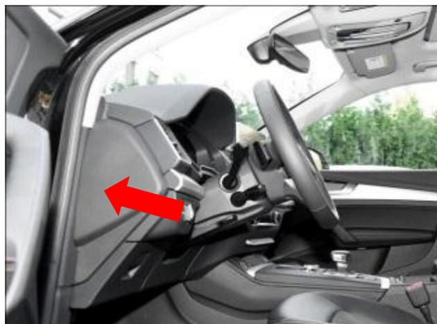
拆内饰件 :把驾驶位中控台拆下 ,并妥善保管 ,后续还原安装。( 箭头 )
